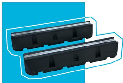
Der Bodensockel (bestehend aus zwei Einzelteilen) eignet sich zur gedämpften Aufstellung von Split-Außeneinheiten. Die Bodenkonsole besteht aus witterungsbeständigem Kautschukgranulat mit eingelassener Alu-Profilschiene (21 x 15 mm). Geeignet für Umgebungstemperaturen von -40 °C bis +80 °C.
